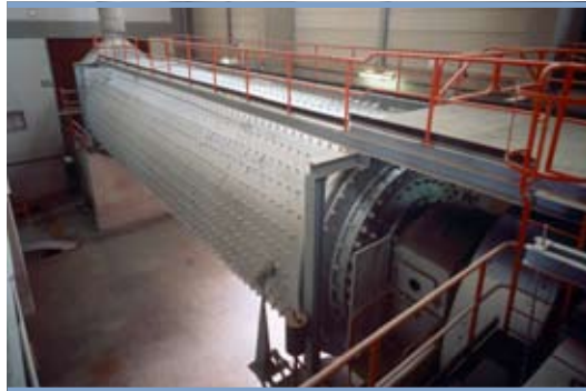
In traditionele kogelmolens wordt de klinker tot een fijn poeder gemalen.
