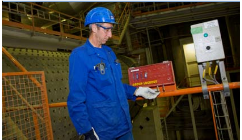
Le collaborateur ne peut commencer l'opération de maintenance que lorsque l'installation est consignée
