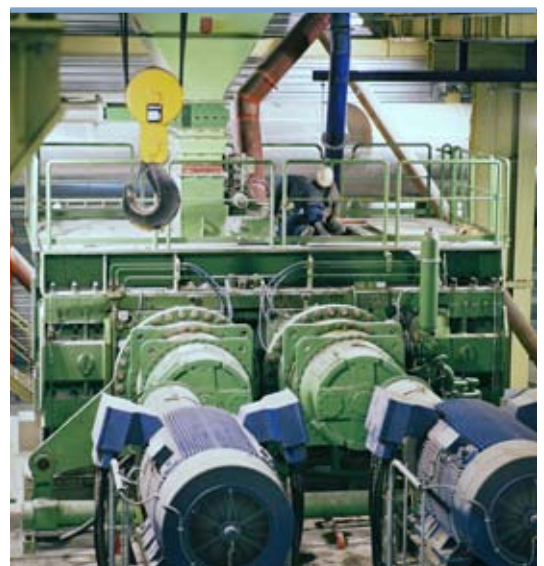
La presse à rouleaux à haut rendement énergétique permet d'économiser 20% sur la consommation totale d'énergie de Gand.
