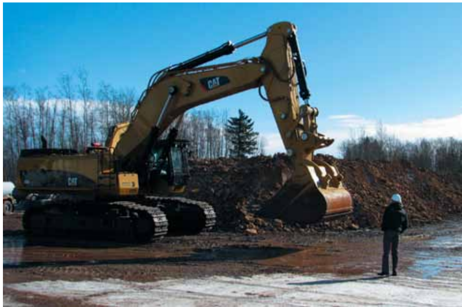
Märtsi lõpus alustas Ubja karjääris tööd Eesti suurim hüdrauliline ekskavaator, millega eemaldatakse põlevkivikarjääris katendit ja kobestatakse ning laetakse põlevkivi.
