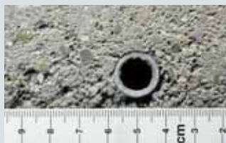
Konventioneller erdfuchter Estrich auf Fußbodenheizung (Querschnitt): Hohlräume verhindern den schnellen Wärmehintransport an die Oberfläche.
