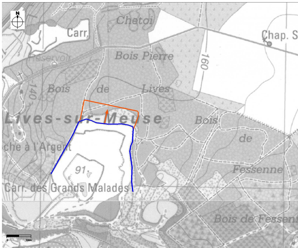
Figure 1 : Elargissement (en orange) de la fosse existante (en bleu) dans la carrière de Bossimé pendant les deux premières années
