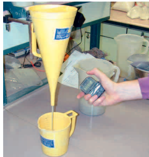
Ermittlung der Marshzeit nach dem Anmischen
