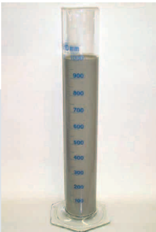
Ermittlung des Wasserabsetzens von ThermoCem PLUS bei W/F-Wert 0,8
